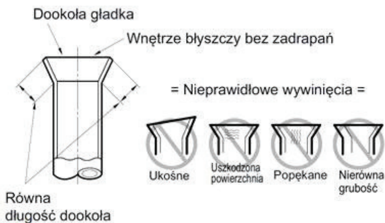
Rys. 22. Zarys prawidłowo wykonanego wywinięcia rury, tzw. kielicha.
