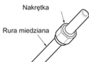
Rys. 20. Proces nasunięcia nakrętek na rury.
