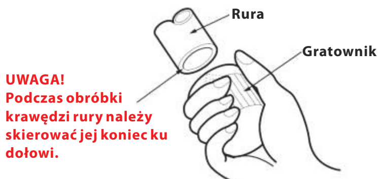
Rys. 18. Proces prawidłowego gratowania krawędzi rury.
