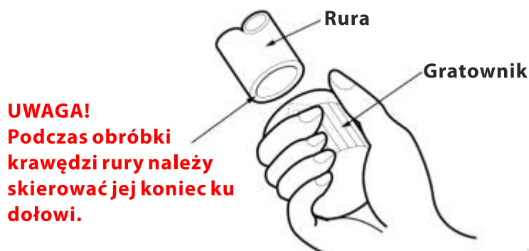
Rys. 20. Proces prawidłowego gratowania krawędzi rury.
