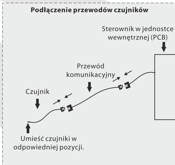
Rys. 35. Połączenie przewodów czujników temperatury.
