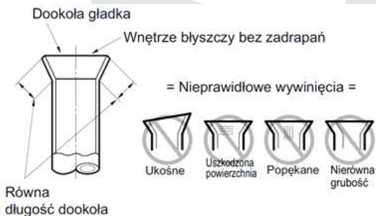
Rys. 24. Zarys prawidłowo wykonanego wywinięcia rury, tzw. kielicha.
